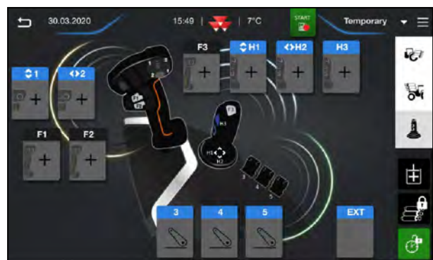
Fig. 182 Pantalla del menú Multi Function Joystick avanzado - Configuración del reposabrazos según la opción solicitada por el operador
